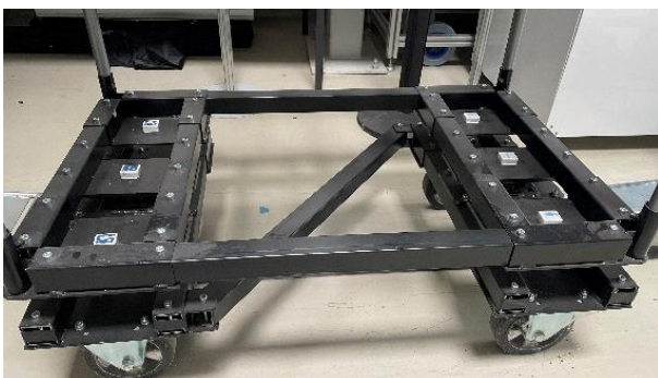
Abbildung 4. Platzierung der Sensoren an der Unterseite des FTS
