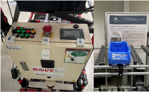
Abbildung 3. Platzierung der Sensorensätze, links Montage an der Front, rechts Platzierung in einem KLT
