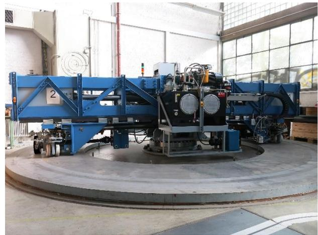
Abbildung 2. Aufbau des Radprüfstandes am IFT.
