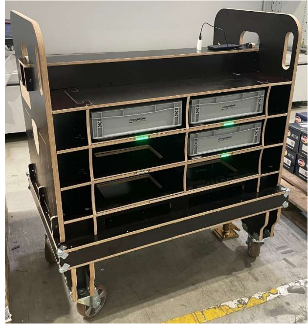
Abbildung 3. Transportplattform mit Sonderladungsträger zur Beförderung von Standardbehältern
