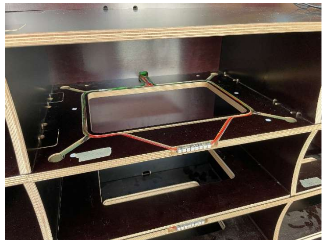
Abbildung 4. Sensorik zur Erfassung des Füllgewichts von mit Kleinteilen befüllten Standardbehältern
