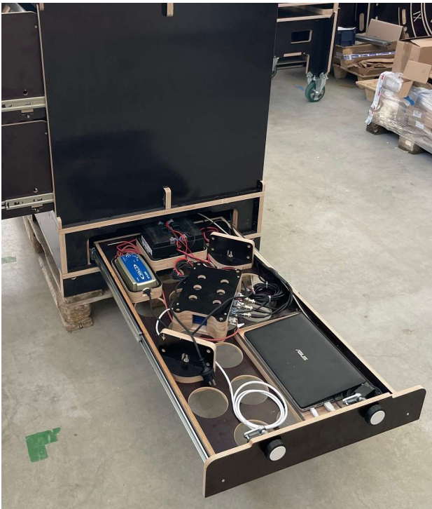
Abbildung 9. Schubfach mit Holzbauteilen für elektronische Komponenten
