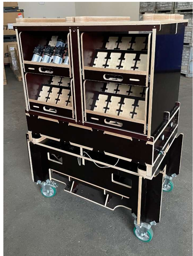
Abbildung 2. Ladungsträger mit Holzkufer auf einem Transportwagen mit Hubwagen- und starrem Stapel-Adapter
