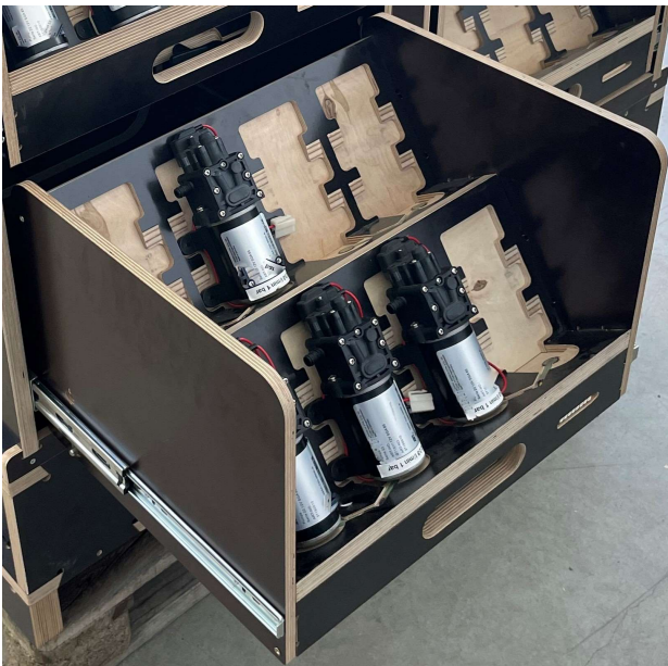
Abbildung 5. Bauteilaufnahme mit funktionalisierten Holzstrukturelementen
