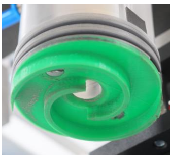
Abbildung 14. Kratzergeometrie mit Kratzblättern, die einer archimedischen Spirale folgen
