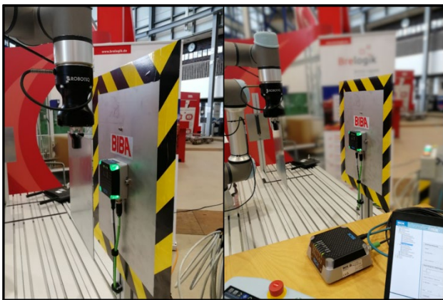
Abbildung 1. Versuchsaufbau: RFID Tag auf Trägerplatte wird von Leichtbauroboter vor RFID Reader positioniert
