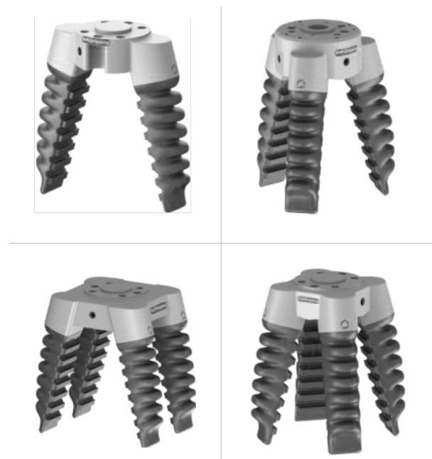
Abbildung 3. Vier Greifergrundarten mit einem Konuswinkel von 75° (In Anlehnung an [SG21]).
